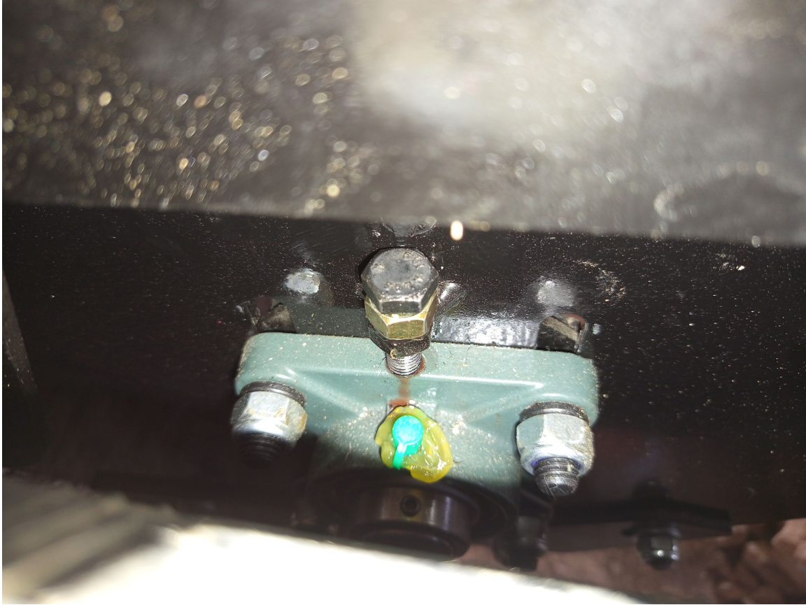
Côté droit, graisseur du roulement du rotor avec vis de réglage de la position
