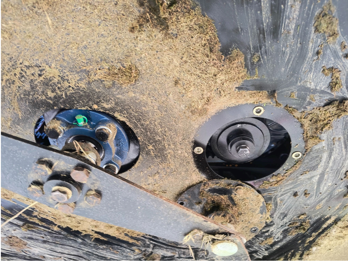
Dessous plateau. Palier du rotor et trappe d'accès à l'arbre du moteur
